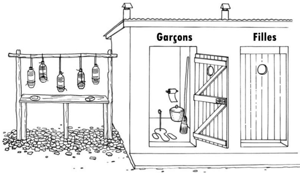
Latrines avec une station de lavage des mains « Tippy Tap » fabriquée à l'aide de bouteilles en plastic vides. La station de lavage des mains est aménagée sur une aire de drainage par infiltration faite de petits cailloux visant à empêcher la formation de flaques.
