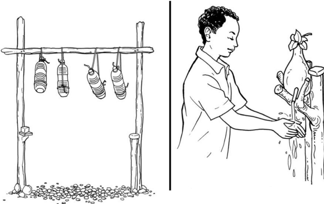
Les stations de lavage des mains peuvent être aussi simples qu'efficaces. L'utilisation de Tippy Taps fabriqués à partir de bouteilles ou dealebasses permet également d'économiser l'eau.
