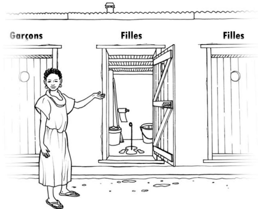
Latrines séparées pour les garçons et les filles, avec du matériel de ménage, de lavage et de nettoyage anal. Elles sont équipées d'un verrou intérieur pour préserver l'intimité et d'une dalle lavable.
